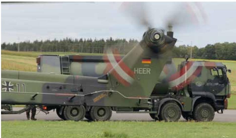
**Die Heeresflieger sind mit ihrem Fuhrpark verlegefähig. Eine Betankung im Gelände ist mit den Allradfahrzeugen überall möglich. Hier ein geschützter Straßentankwagen des Luftfahrzeugversorgungszuges der 4./30.**
