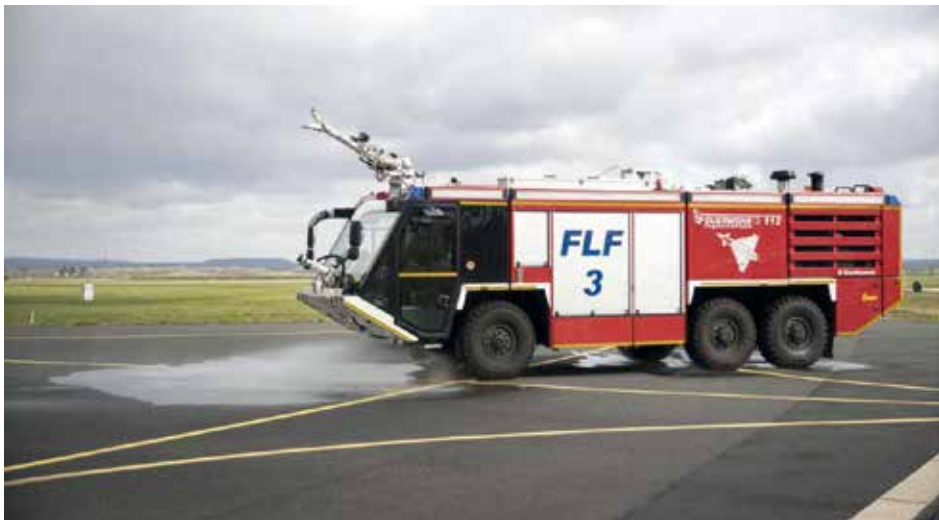
Die Bundeswehrfeuerwehr im Einsatz mit ihrem Flugfeldlöschfahrzeug Z6. Hiermit können bis zu 6.000 Liter Wasser zum Löschen von Bränden aufgenommen werden. (Quelle: Bundeswehr/Torsten Kraatz)
