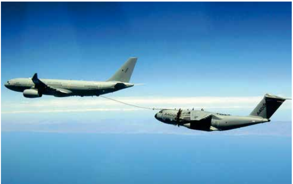
Eine britische A330 MRTT „ Voyager “ betankt einen Airbus A400M . (Quelle: Royal Air Force /Archiv)
