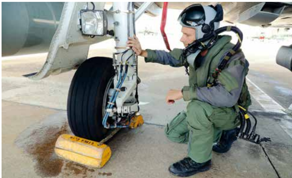
Kontrolle des Hauptfahrwerkreifens vor dem Flug. (Quelle: Luftwaffe/Ulrich Metternich)
