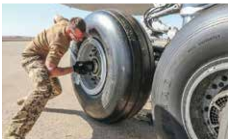
Oberfeldwebel Oliver F. muss viel Kraft einsetzen, um das Befestigungselement (Radmutter) mit 80 – 150 Nm anzuziehen. (Quelle: Bundeswehr/Dustin Ackermann)
