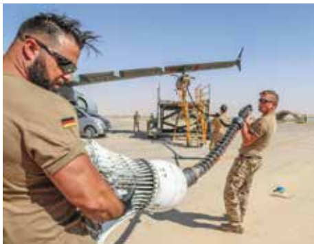
Eine schweißtreibende Arbeit. Der Tankkorb wiegt um die 35 Kilogramm. (Quelle: Bundeswehr/Dustin Ackermann)
