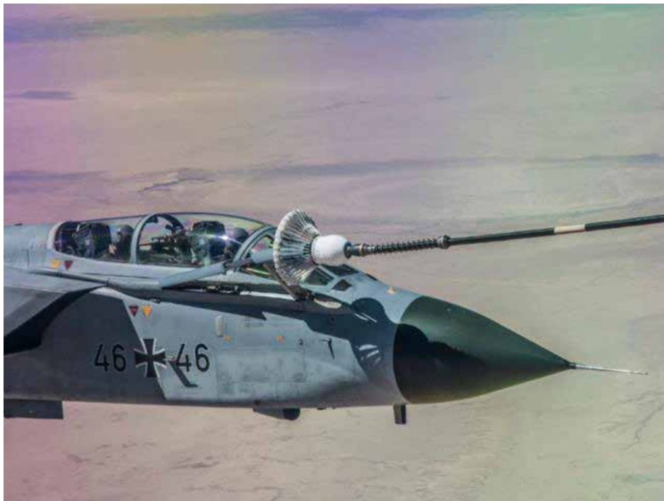
Der Pilot muss mit seinem Betankungsstutzen den 80 Zentimeter großen Tankkorb treffen. (Quelle: Bundeswehr/PAO Counter Daesh)
