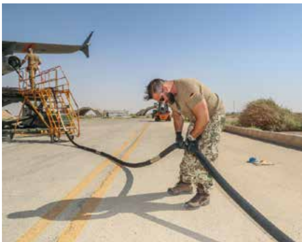
Der Tankschlauch muss nach jedem Einsatzflug überprüft werden. (Quelle: Bundeswehr/Dustin Ackermann)
